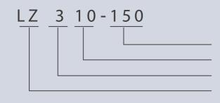
进口口径 SUC.Diameter(mm) 额定功率 Rated power(hp) 相数 Phase
