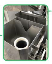
污泥计量槽与絮凝槽由激光 切割的SUS304不锈钢板焊 接而成。
