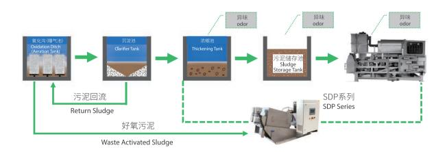
传统的污泥处理在污泥脱水前需要大量的预处理过程,采用SDP脱水工艺可以直接处理来自氧化沟(曝气池)的低浓度污泥,具有去除污泥异味、降低浓缩池及其他相关设备投资成本、不会发生传统污泥浓缩池或储存池中在缺氧或厌氧条件下的污泥磷释放,进一步简化了工艺流程,稳定脱水过程。
