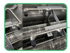
电磁阀自动控制清洗水, 使设备运行保持高效率。
