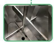
不锈钢SUS304混合搅拌桨,使污泥与絮凝剂充分混合反应,产生矾花。
